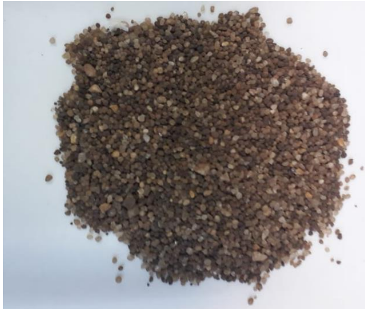
Figura 7: Arena recubierta con óxido de hierro generada como desecho.
