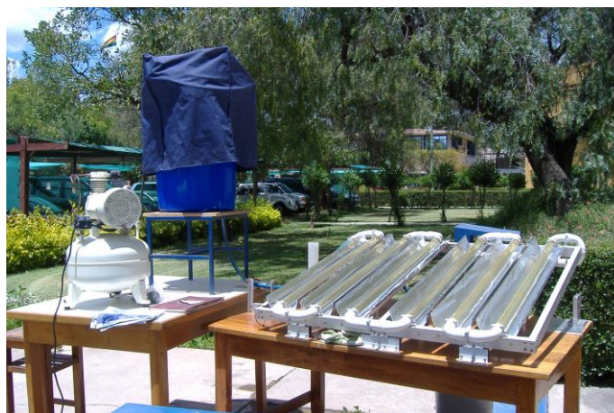
Figura 7 - Concentrador solar para pruebas de flujo continuo.
